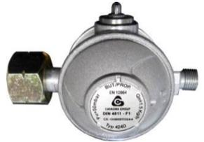
Art.-Nr. 1701-Z/90 **für Außenanlagen** Regler 1,5kg;50mbar;zweistufig für Gewerbe/Industrie mit Sicherheitskontrollanzeige; KLF x G 1/4"LH-KN 90° Ausgang
