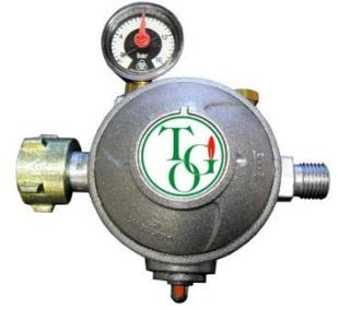
Art.-Nr. 1701-Z **für Außenanlagen** Regler 1,5kg;50mbar;zweistufig für Gewerbe/Industrie mit Sicherheitskontrollanzeige; KLF x G 1/4"LH-KN
